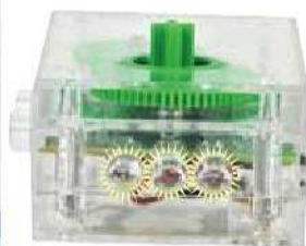
8ème étape La dynamo peut fonctionner comme une lampe. Lorsque tu mets l'interrupteur sur "☀", les trois DEL de la dynamo s'allument pendant plus de 15 minutes.
