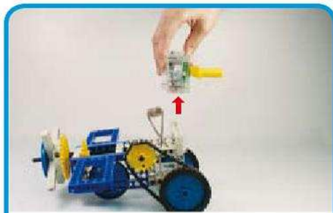
1ère étape Retire la dynamo du modèle réduit.
