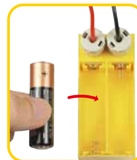
3. Mettez une première pile dans le boîtier (prenez soin de respecter la polarité).
