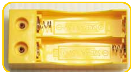
1. Boîtier des piles à 3V avec marques de polarité (+/-).
