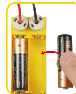
4. Mettez la deuxième pile dans le boîtier (prenez soin de respecter la polarité). Ce boîtier fonctionne uniquement avec deux piles, pas avec une seule.
