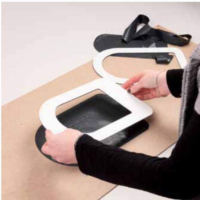
Placer sur la pièce en cours de réalisation le gabarit B.
