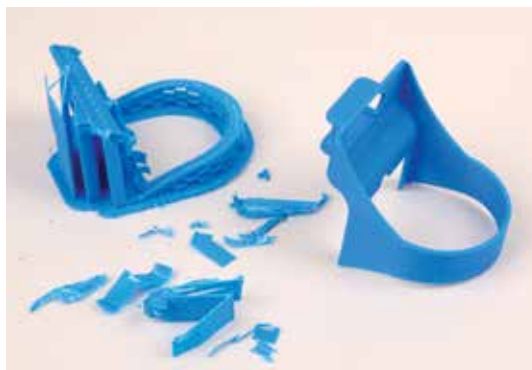
Réalisation du support mono-gouverne avec l'imprimante 3D UP EASY120
