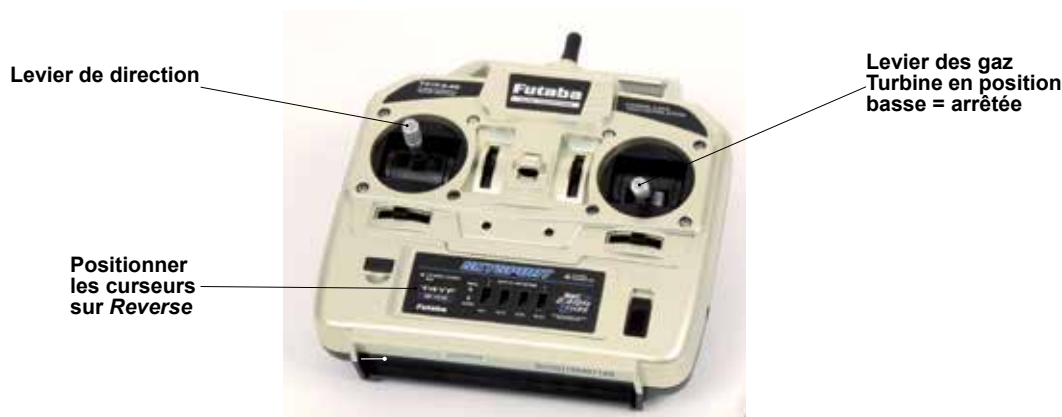
Radiocommande Futaba 2,4GHz 4 voies Elle est livrée avec le levier des gaz à droite (mode 1).
