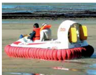
b. Autre système de guidage : double-gouverne
