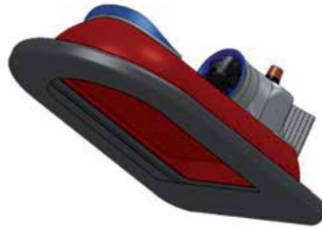
b. Jupe souple soufflée (modèle réduit)
