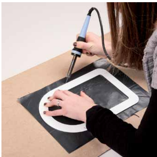
Au moyen du fer à souder, découper ensemble le contour extérieur des deux pièces superposées.
