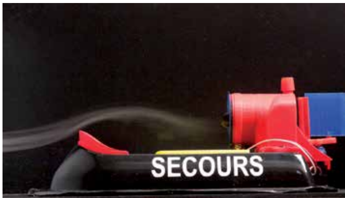
b. Flux laminaires sur le pare-brise de l'aéroglesseur
