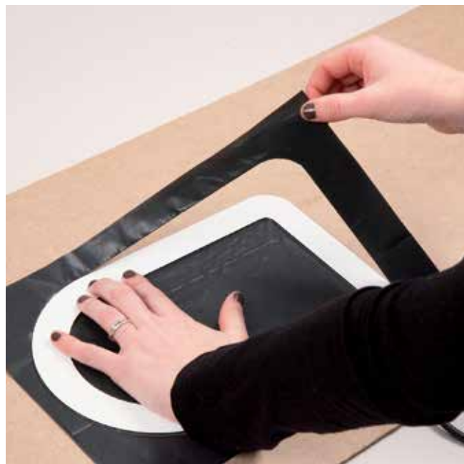
Cela découpe les pièces en même temps que ça les soude entre elles.
