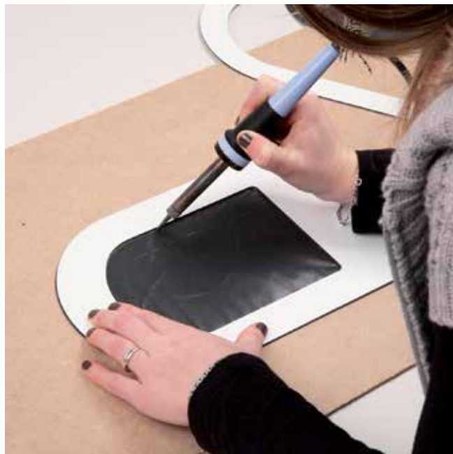
Découper au moyen du fer à souder le trou plus petit de la demi-jupe inférieure B.
