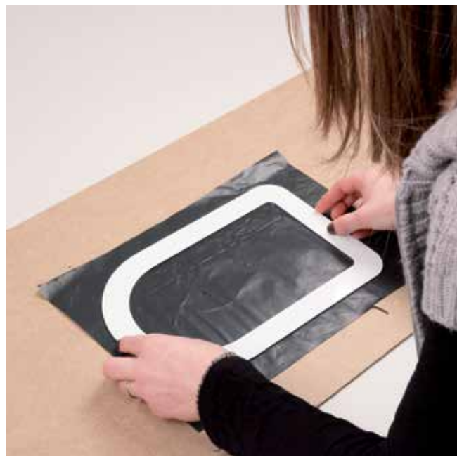
Placer le gabarit A dessus en ajustant bien le gabarit avec le trou central de la pièce.
