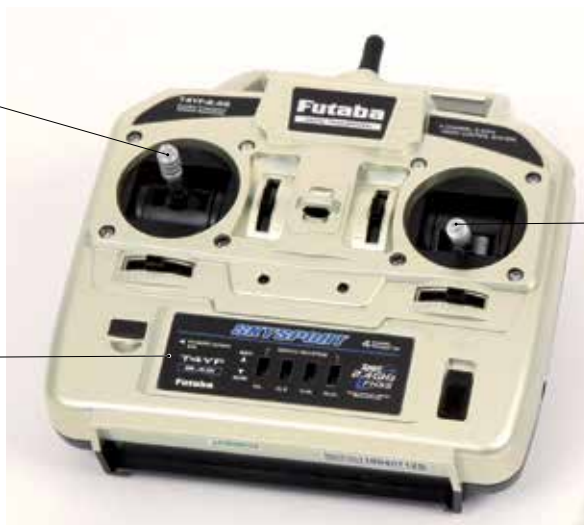
Radiocommande Futaba 2,4GHz 4 voies Elle est livrée avec le levier des gaz à droite (mode 1).
