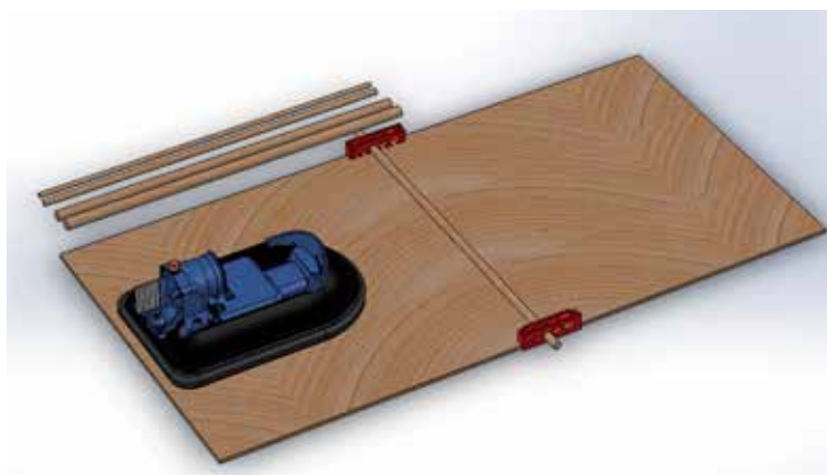
Passage d'obstacles avec le modèle réduit d'aéroglesseur léger
