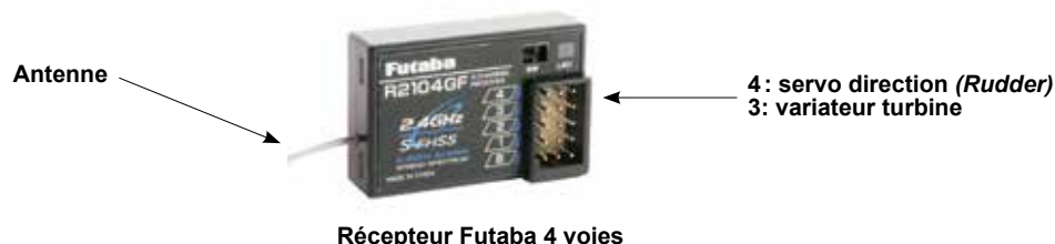
Radiocommande Futaba 2,4GHz 4 voies Elle est livrée avec le levier des gaz à droite (mode 1).
