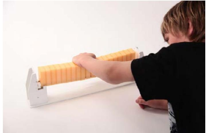
En testant la poutre dans un sens ou dans l'autre, l'élève découvre qu'une armature n'est efficace que si elle travaille en traction. Il faut donc qu'elle soit placée dans la partie tendue de la poutre sinon celle-ci fléchit.
