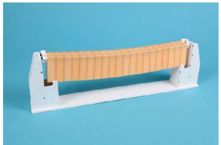
Lorsque l'armature est située en partie haute, par son propre poids la poutre peut fléchir.
