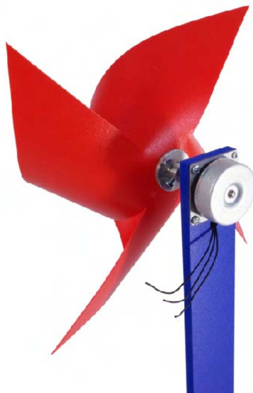
Exemple d'un montage différent que celui détaillé dans ce dossier : ici la partie électrique reste fixe. Les DEL peuvent alors être fixées sur le support ou déportées plus loin pour simuler l'alimentation électrique d'un édifice.
