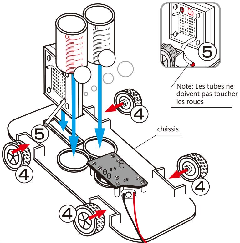
3. Brancher le tube de caoutchouc muni du bouchon noir sur l'embout inférieur de la pile à combustible côté H2 (Hydrogène).
