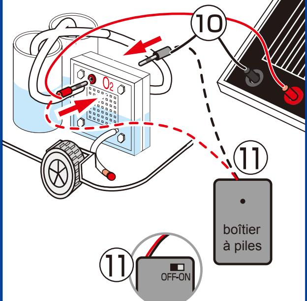
**11.** ALTERNATIVE: brancher le câble rouge du boîtier à piles dans la prise rouge de la pile à combustible. Brancher le câble noir du boîtier à piles dans la prise noire de la pile à combustible. Placer le commutateur du boîtier de batteries en position marche « ON ».
