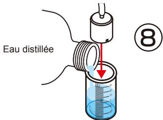
Note : pour les remplissages ultérieurs, alors que les cloches internes sont déjà en place dans les cylindres et munies des longs tubes à leur sommet, extraire les deux petits bouchons rouge et noir des tuyaux courts sur la pile à combustible afin que l'eau puisse monter à l'intérieur des cloches. Dès que les cloches sont pleines d'eau, rebrancher les tubes sur les embouts respectifs de la pile à combustible.
