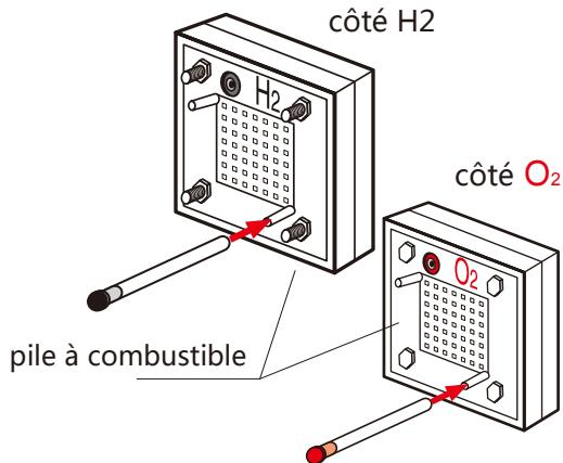
7. Enlever le bouchon rouge du tube court de la pile à combustible côté O2 et, à l'aide de la seringue, injecter de l'eau distillée à l'intérieur de la pile à combustible jusqu'à la moitié de la hauteur.
