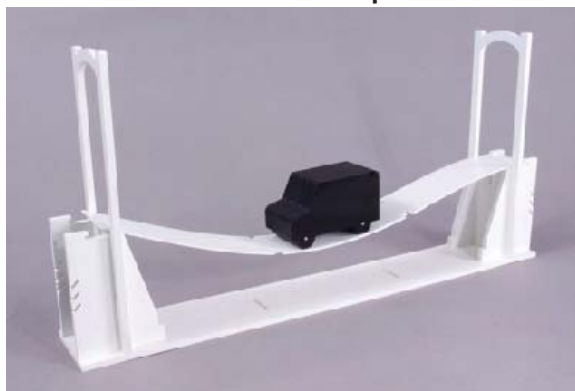
1 - Test avec une charge, sans maintien du tablier. On constate la nécessité que le tablier soit soutenu.
