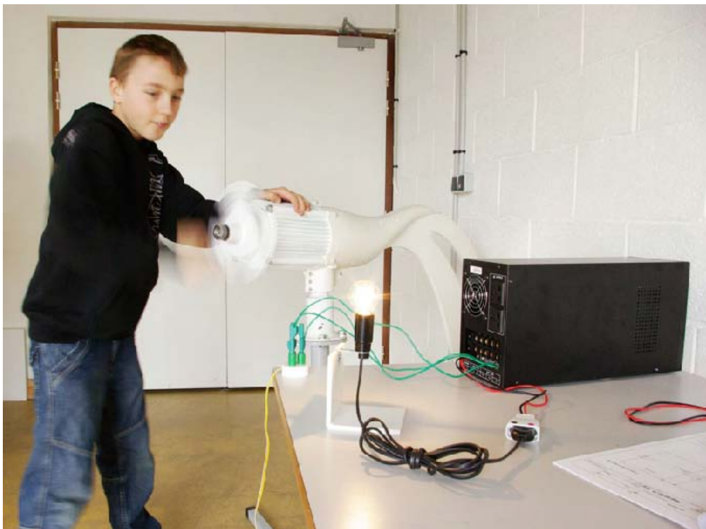
La manivelle montée à la place de l'hélice permet de réaliser des tests en classe
