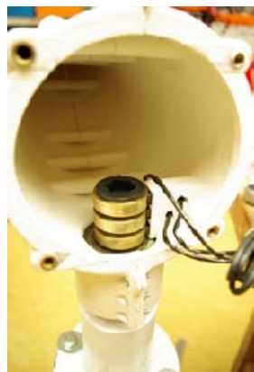
Vue du collecteur rotatif, générateur démonté.
