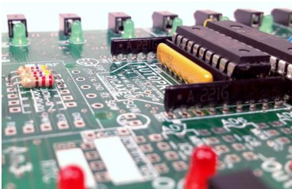
Détails résistors et diode de redressement
