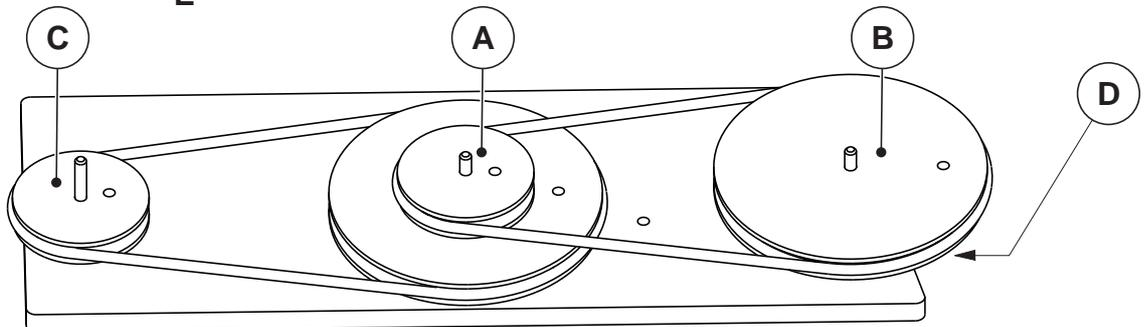
Tourner la poulie **C** dans un sens et noter sur le dessin avec des flèches les sens de rotation des poulies **C**, **A**, **B**.
