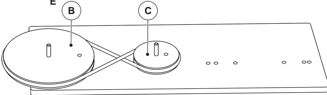
Tourner la poulie **B** dans un sens et noter sur le dessin avec des flèches les sens de rotation des poulies **B** et **C**.
