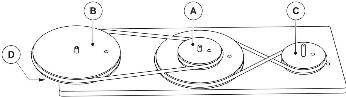
Tourner la poulie **B** dans un sens et noter sur le dessin avec des flèches les sens de rotation des poulies **B, A, C**.
