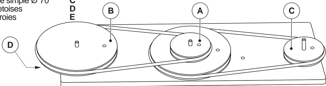
Tourner la poulie **B** dans un sens et noter sur le dessin avec des flèches les sens de rotation des poulies **B, A, C**.
