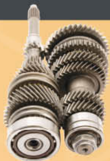
les engrenages permettent au conducteur de changer de vitesse
