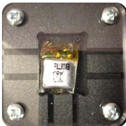
Batterie LiPo déportée sur le banc d'essai Caractéristiques : 3,7 V / 55 mAh.
