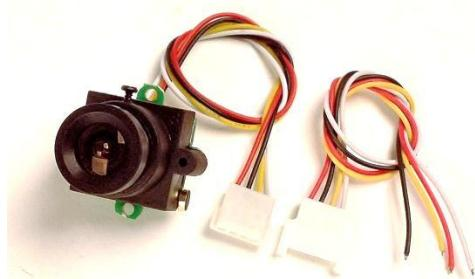
Elle peut être aisément installée sur une tourelle animée par des servomoteurs en vue de contrôler son orientation. Cette caméra miniature CMOS est très légère, elle est sensible sous très faible éclairement à partir de 0,008 Lux.
