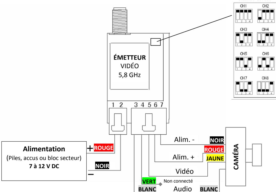
La caméra est alimentée au travers de l'émetteur. Le récepteur est alimenté avec son bloc secteur et relié à un moniteur vidéo.
