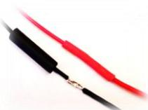
On assure les liaisons en soudant les fils. On utilise de la gaine thermo-rétrécutable pour assurer la bonne isolation entre les interconnexions.
